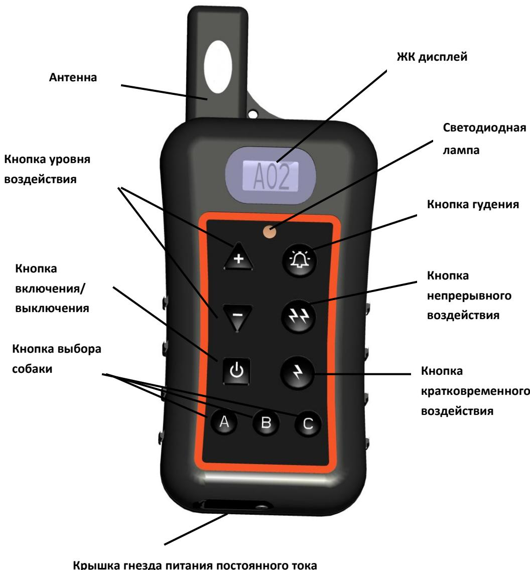
Кнопки “+” и “-”: нажмите эти кнопки для регулировки интенсивности электростатического воздействия от 1 до 10 уровня
